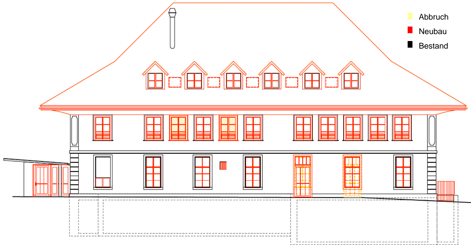
Nordfassade geplante Eingriffe Fassade
