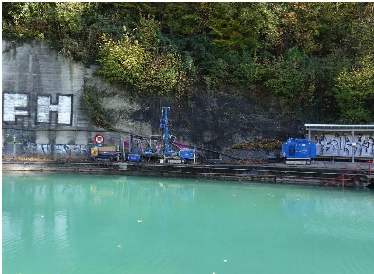
Bestandesuntersuchungen Beton- und Baugrunduntersuchungen vor Ort
